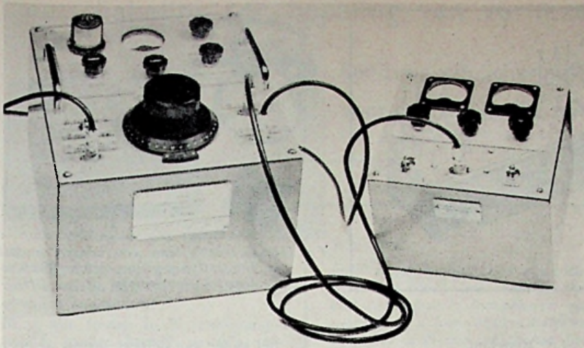
Fig. 4. Links de brug verbonden met de 30 Hz spanningsbron
