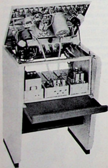
Afb. 4. Het loopwerk kan worden omhooggeklapt om het storingzoeken te vereenvoudigen
