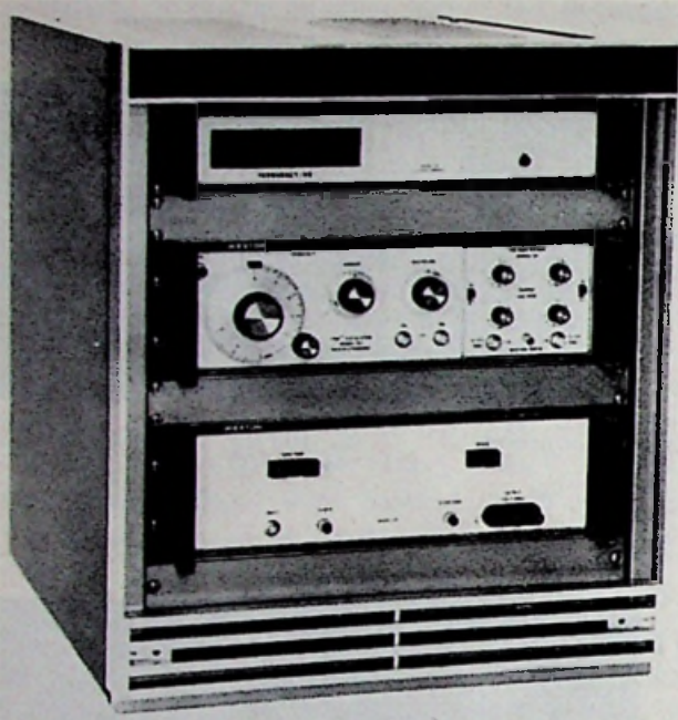
Fig. 10. De CVO-100 samengebouwd met een versterker en een digitale frequentiemeter
